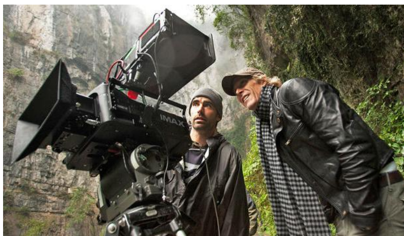
Obrázok 35 4K IMAX 3D kamera - paralelné postavenie objektívov
